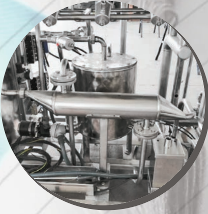
Proses koşullarında hızlı ısıtılabilen buhar eşanjörü Steam exchanger with rapid heating during processing
